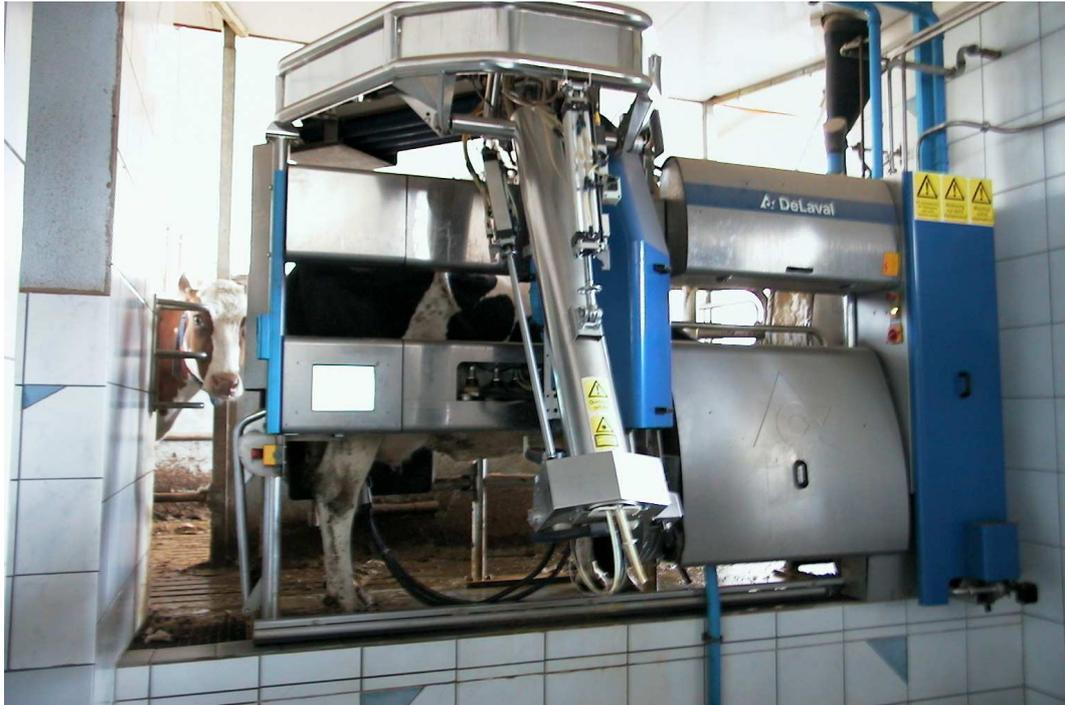
Bild 1: Automatisches Melksystem VMS der Firma DeLaval
