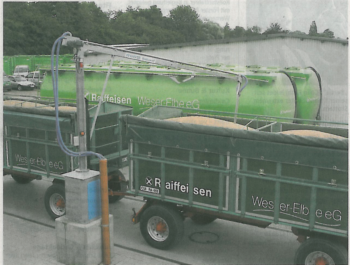
Ferngesteuert können bei der Raiffeisen Weser-Elbe in Otterndorf jetzt bereits auf der Waage Getreideproben aus den Anhängern entnommen und im Labor in kürzester Zeit präzise ausgewertet werden. Foto: Rohde
