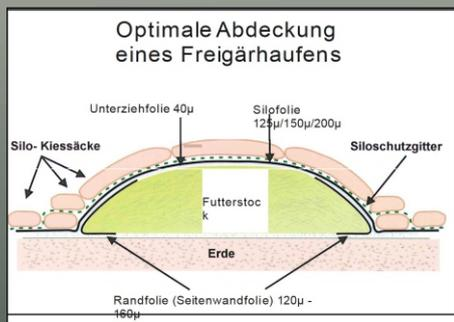
Optimale Abdeckung eines Freigärhaufens
